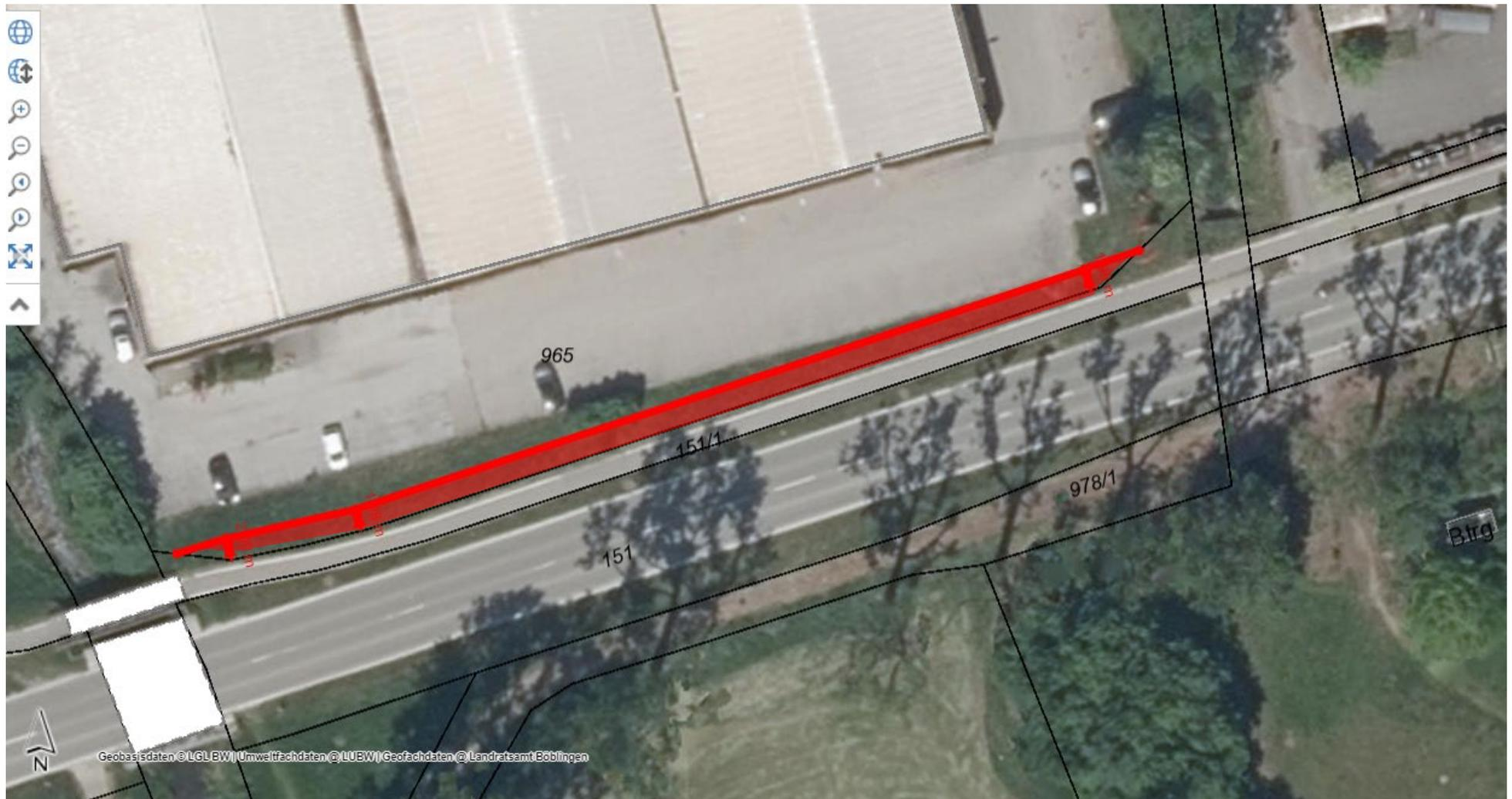
Der rötlich markierte Bereich stellt die aktuell bepflanzte Fläche dar, die für die Verbreiterung des Radweges benötigt wird. Der Bereich ist rund 90 m lang und 2 m breit.
